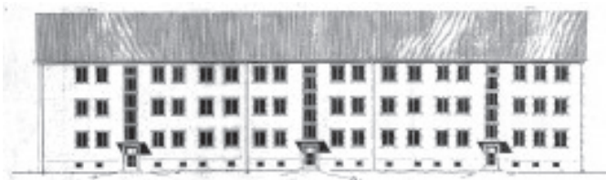
Grundriss und Ansicht dreigeschossiges Wohngebäude A.-S.-Makarenko-Straße 13/15/17 in Ziegelgroßblockbauweise
